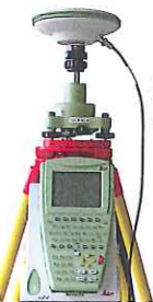
Figura 2 Ricevitore geodetico Leica
