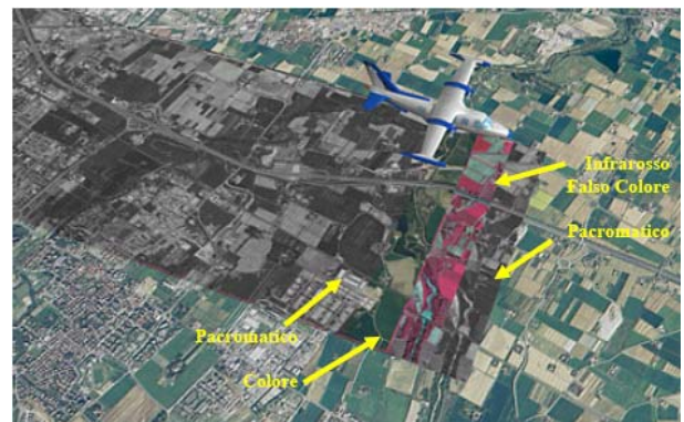
Figura 2: Strisciate acquisite dal sensore ADS40
